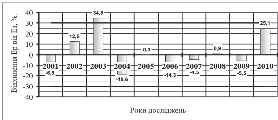
Рисунок 3. Відхилення величин сумарного випарування, заміряного сумарним рисовим випаровувачем і розрахованого по формулі 1, % (2001-2010 рр.)
