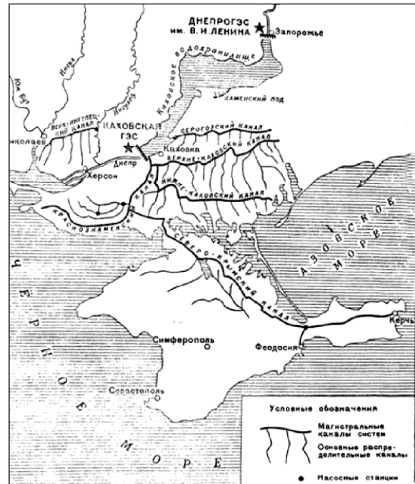
Рисунок 1. Проектна схема зрошення півдня України на основі Каховського гідровузла
