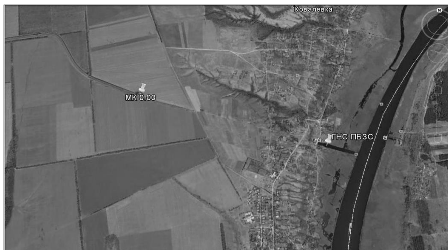
Рисунок 1. Початок Південно-Бузької зрошувальної системи. ГНС ПБЗС – головна насосна станція Південно-Бузької зрошувальної системи; МК 0.00 – початковий магістральний канал ПБЗС (2,3 км від ГНС)
